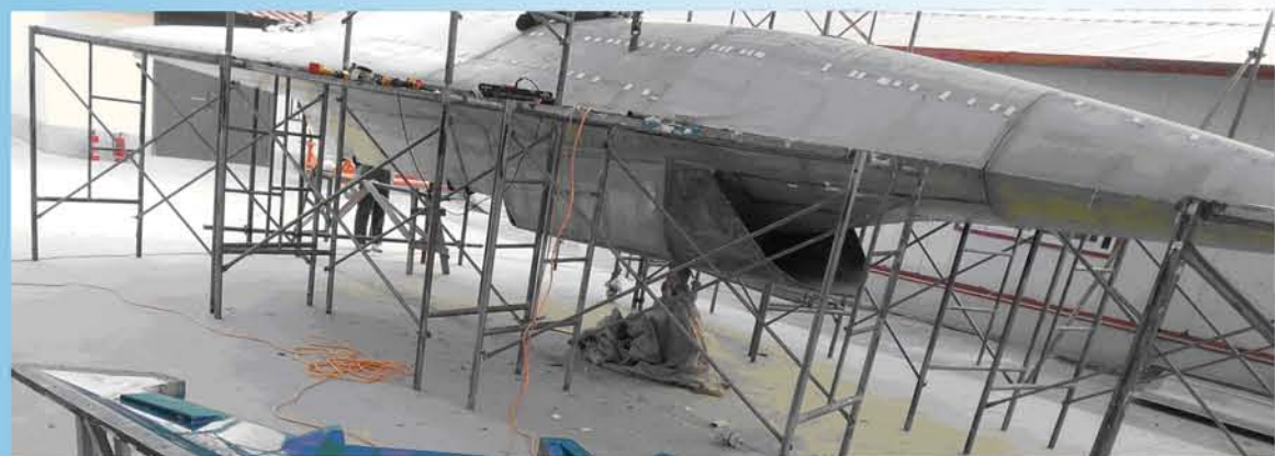
▲ 大型飞机蒙皮制造
