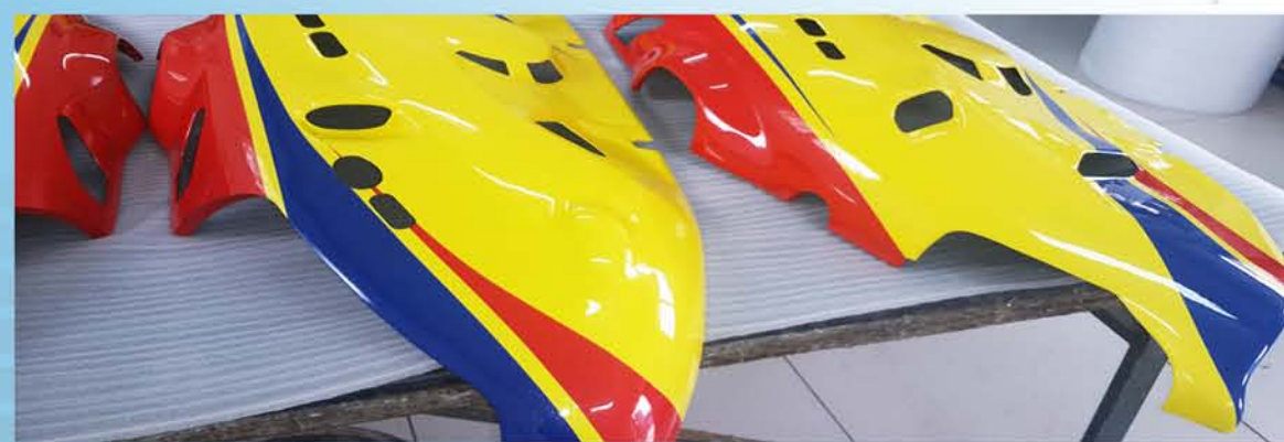
大型无人直升机机壳 ▲ 制作及彩漆套色喷涂
