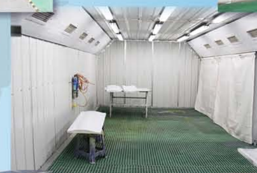
喷漆房 组合风压水过滤一体式
