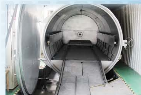
电动升降平台低压热压罐 Φ2.5m*6m, 150℃自动控温 ±0.1MPa自动控压 有效容积23m 3
