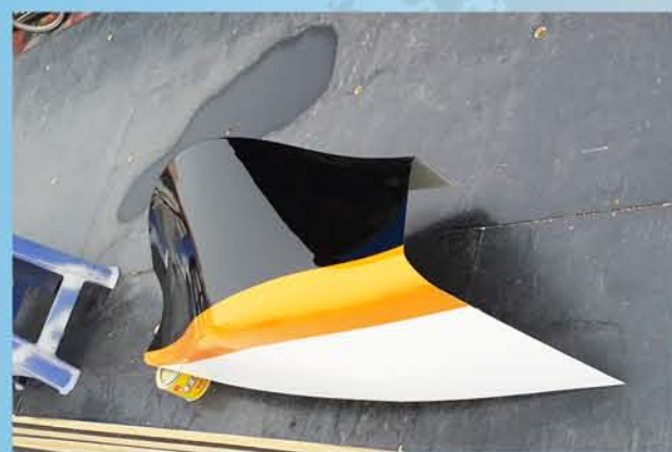
▲ 小F1赛车车壳 制作及彩漆套色喷涂
